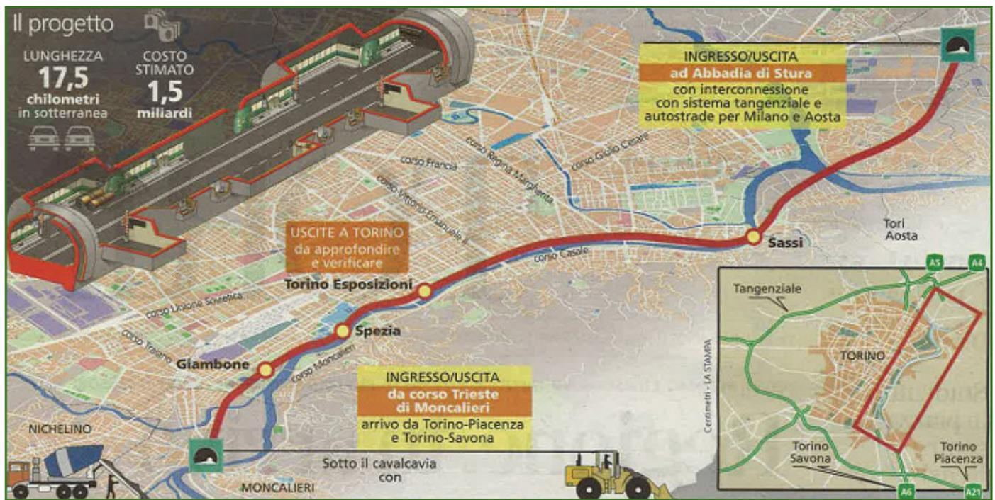
Schema del tracciato del tunnel sotto il Po
